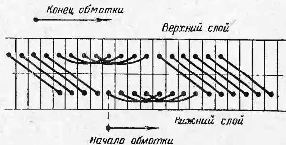
Рис. 13. Торцовая схема укладки обмотки.
